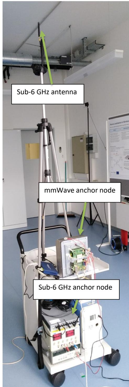
Figure 5-7. Mobile node/UE - mmWave and sub-6 GHz.
